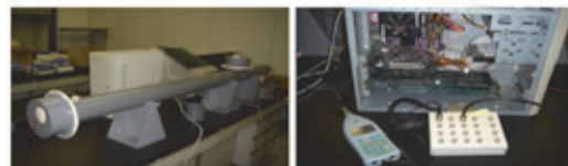
ダクト ANC 模擬システム
